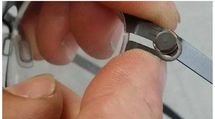
Führen Sie nun den offenen Bogen des Gelenks zum Bolzen und legen die Spitze in den Spalt zwischen Bolzen und Bügel.
