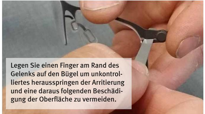
Legen Sie einen Finger am Rand des Gelenks auf den Bügel um unkontrolliertes Herauspringen der Arretierung und eine daraus folgende Beschädigung der Oberfläche zu vermeiden.
