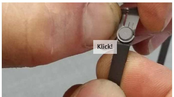
Mit einem letzten festen Druck rastet der Bogen in seine Arretierung ein. Das Gelenk ist nun geschlossen und hält das Glas sicher.
