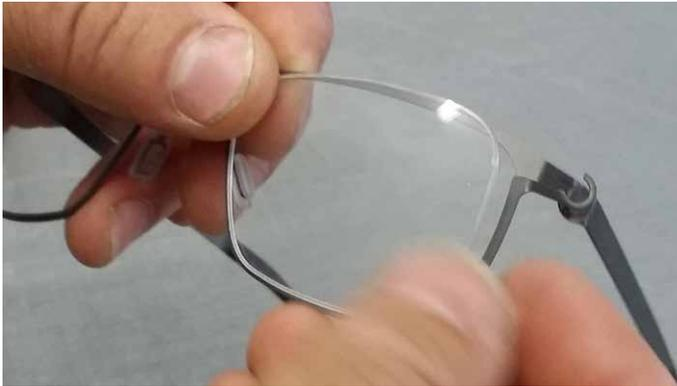
Halten Sie die Fassung mit festem Griff in der Hand. Legen Sie das Glas zunächst am Steg an. Führen Sie den unteren Rahmenteil in die Nut des Glases.
